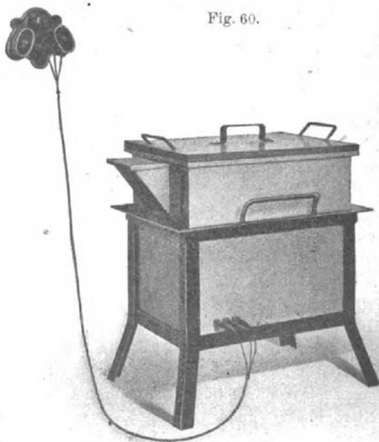
Elektrischer Dynamitauftauapparat (im Betrieb).
